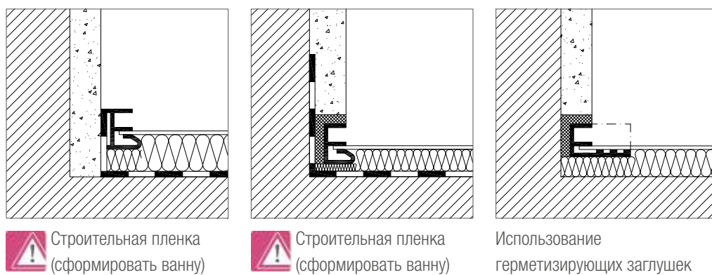
Рис. 15: Герметизация в местах бокового примыкания отлива
