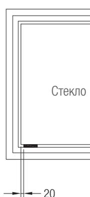
В отдельных случаях расстояние до подкладки может быть сокращено до 20 мм, если при этом не возникает риск разрушения стекла.
